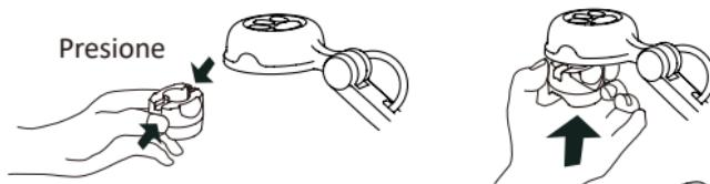
4. Conecte el lente en conjunto con el adaptador al microscopio.
