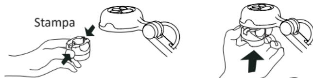
4. Collegare la lente con l'adattatore per microscopio al microscopio.
