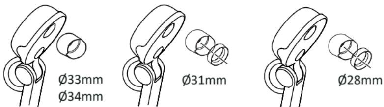
3. Montare l'adattatore del microscopio sull'obiettivo.
