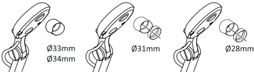
3. Montare l'adattatore del microscopio sull'obiettivo.
