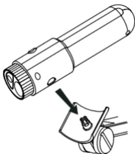
USBケーブルを提供されたケーブルホルダーに沿わせて配置する
